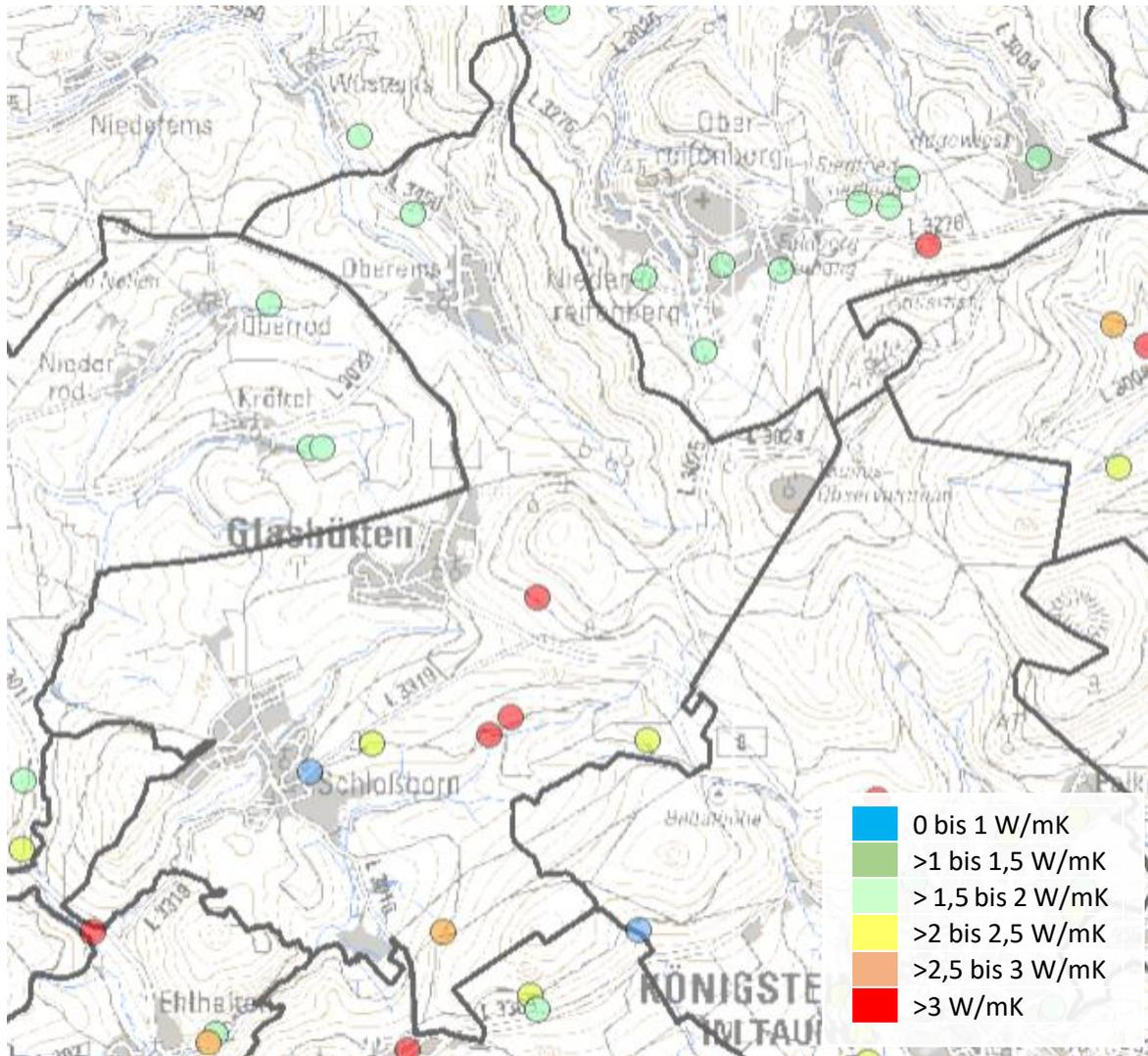
Abbildung 37: Darstellung der mittleren Wärmeleitfähigkeit (40 m Bohrtiefe). Quelle der Daten inkl. Legende: HLNUG
